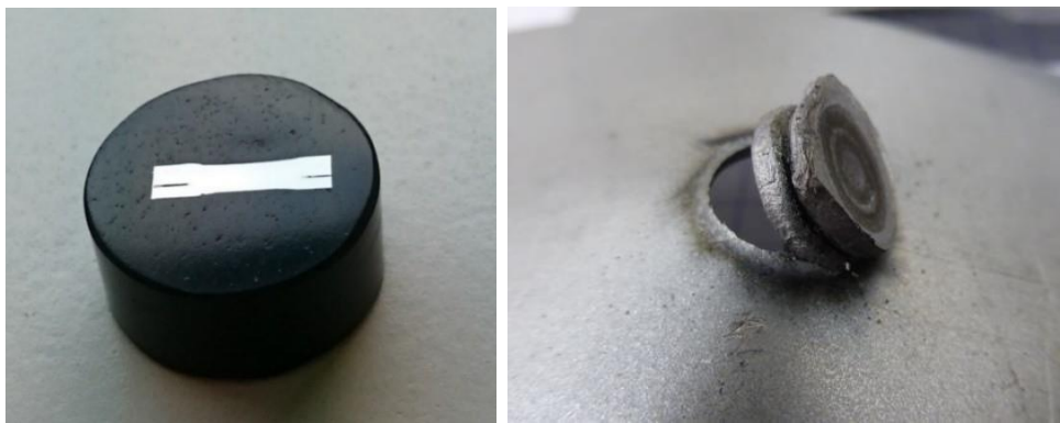
Figure 1.4 - Point découpé et enrobé (gauche) et point arraché (droite).
