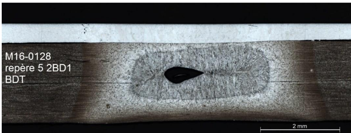
Figure 1.5 - Coupe macrographique d'un assemblage dissymétrique de deux tôles (AM54 0,57 mm / DP600 2 mm) (étude interne ArcelorMittal).
