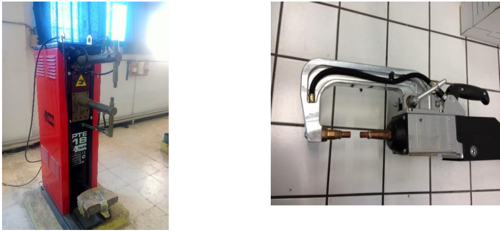
Figure 1.3 - Soudeuse piédestal (gauche) et pince de soudage (droite).
