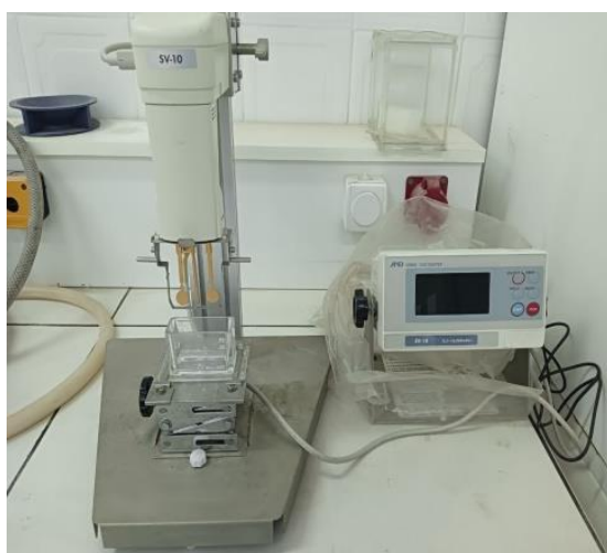
Figure III.3: Viscosimètre à vibration SV-10
