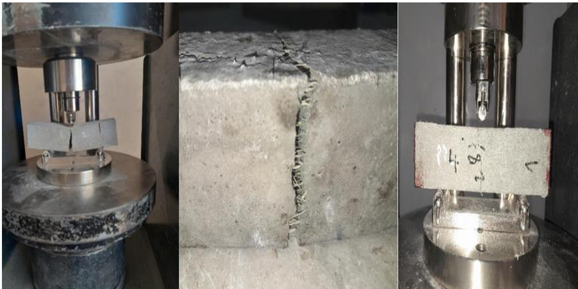
Figure . II.15 : Essai de traction par flexion sur des éprouvette
