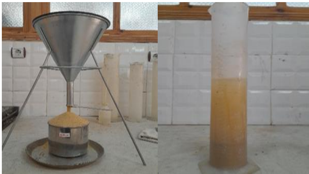
Figure. II.9 : essai Masse volumique (absolue et apparent)
