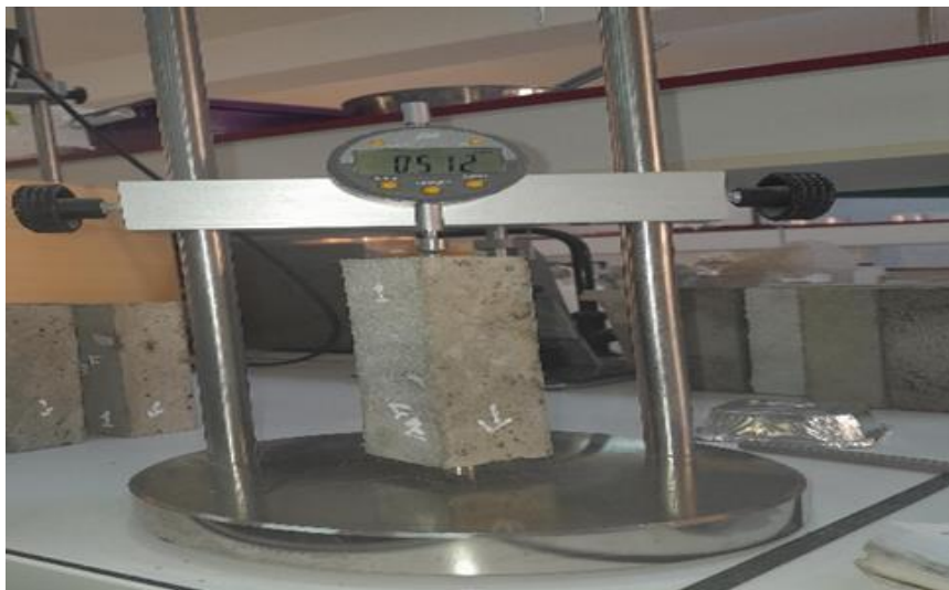
Figure. II.18 : Mesure de retrait sur des éprouvettes
