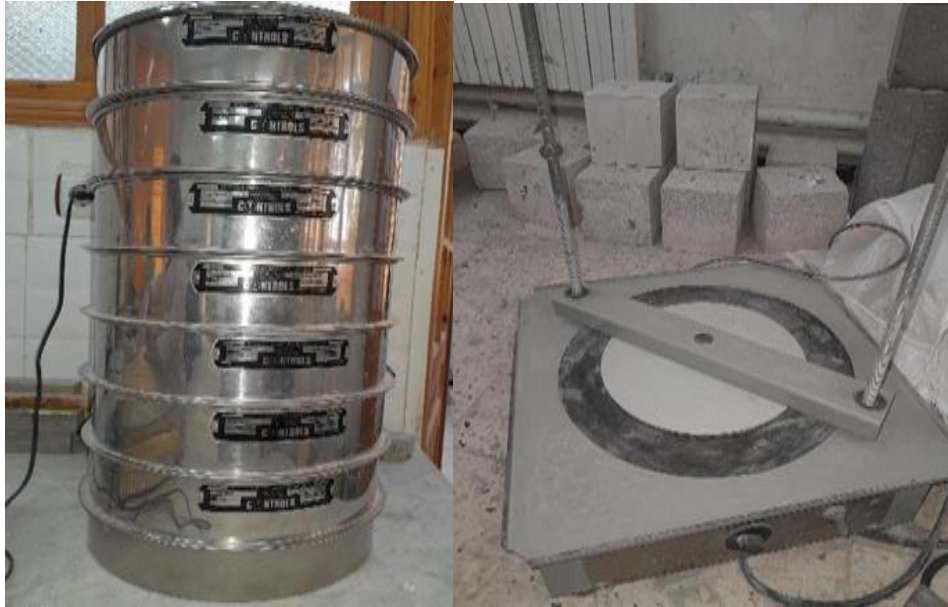
Figure .II.8: Série de tamis et table de vibration
