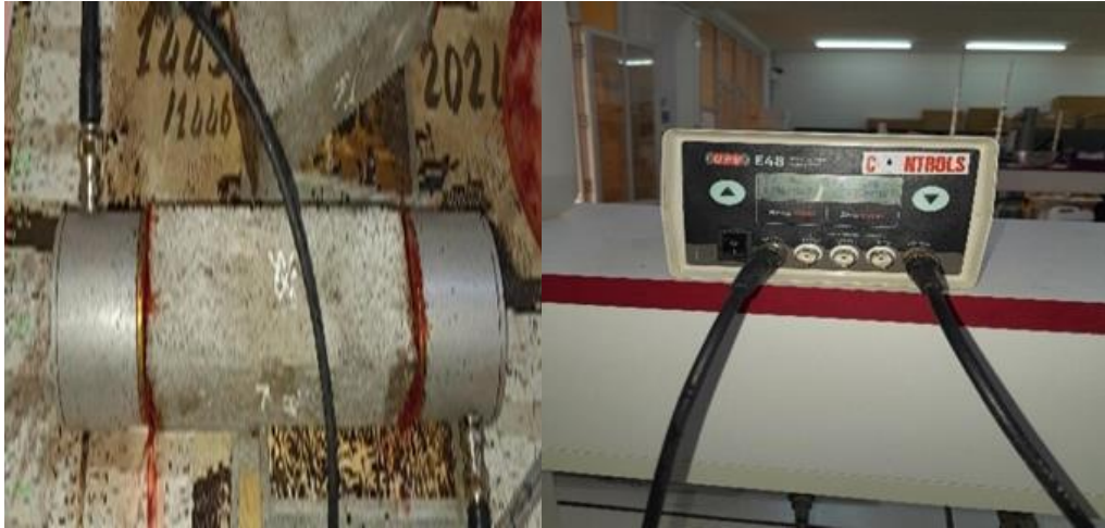
Figure II.17: Essai d'ultrason sur des éprouvettes
