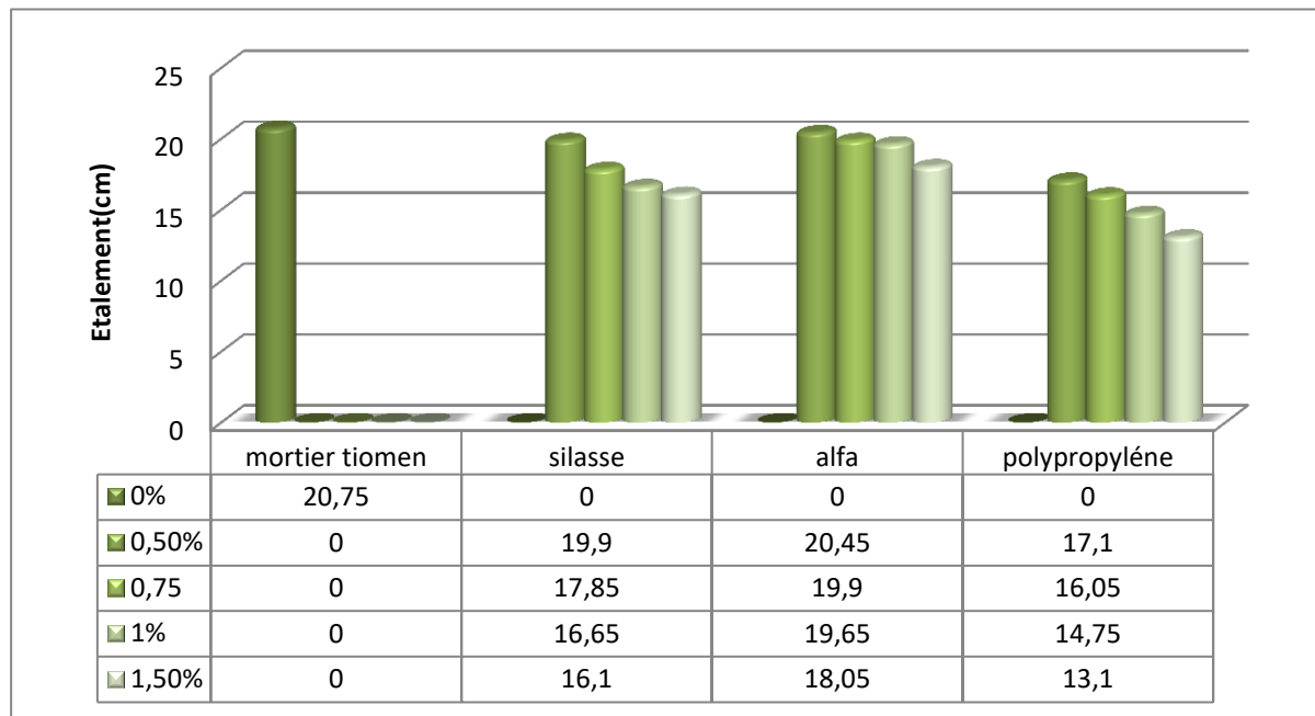
Figure. III .1 : l’effet des fibres de sisal, Alfa et polypropylènes sur la maniabilité de mortier
