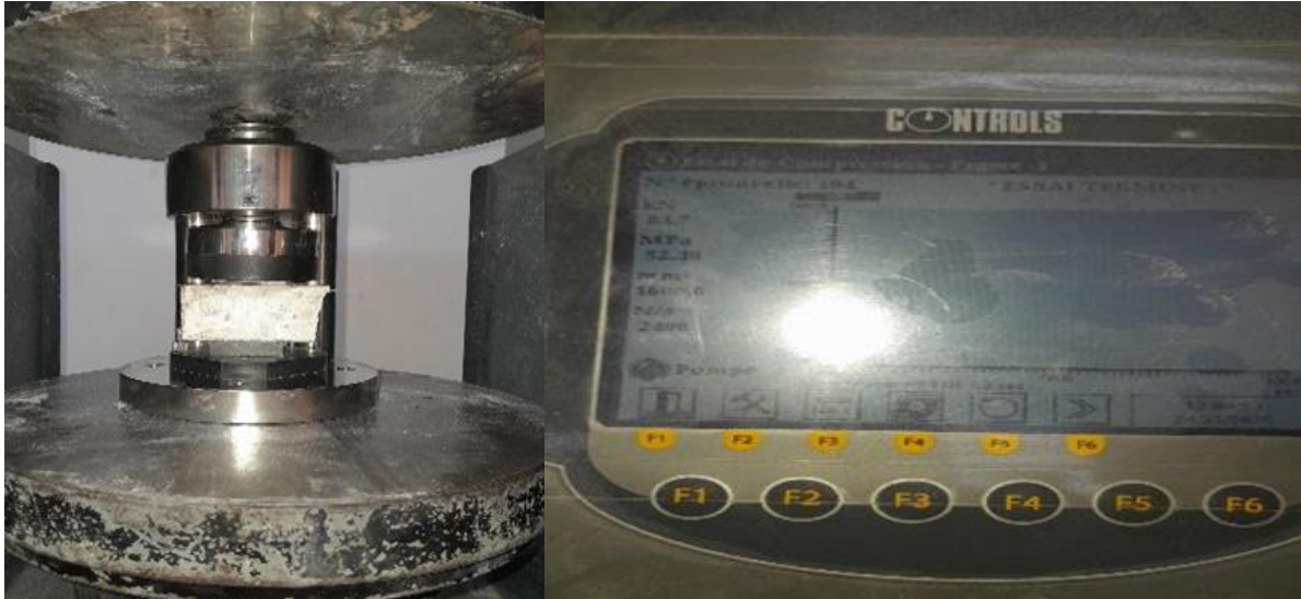
Figure. II.16 : Essai de compression sur des éprouvettes
