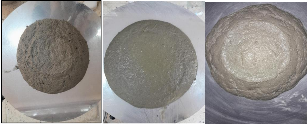
Figure. II.13 : Essai d'étalement à la table à secousses
