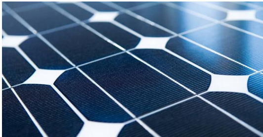
a) Cellule de silicium monocristallin
