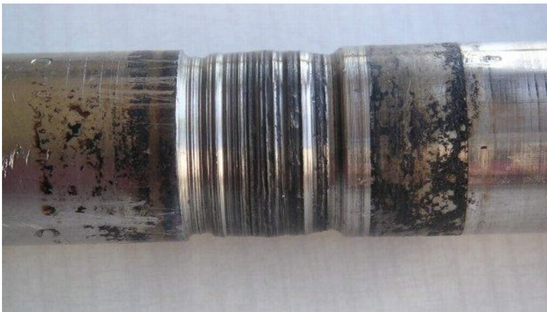
FIGURE 1.7 – Usure par abrasion
