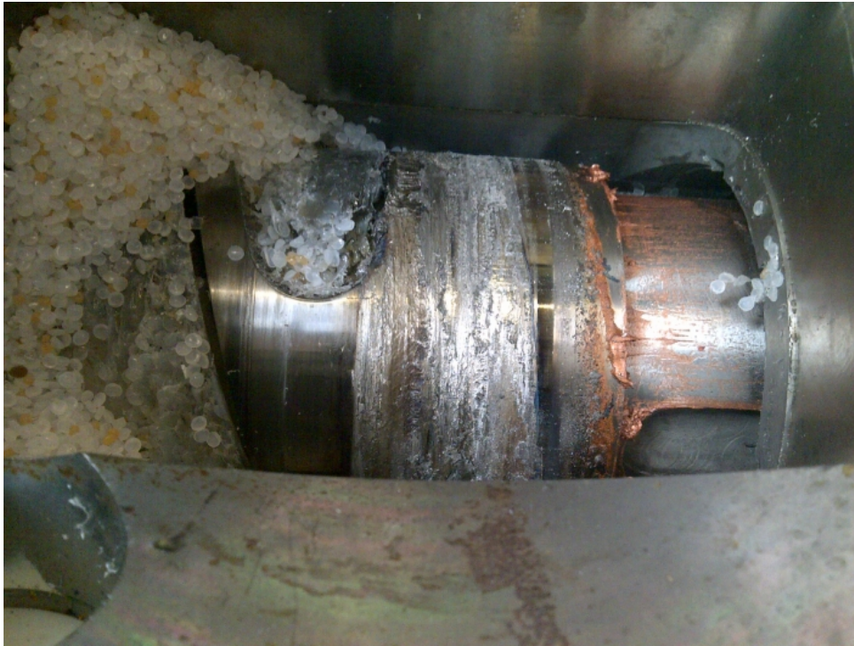
FIGURE 1.6 – Grippage d'un talon de vis d'extrusion
