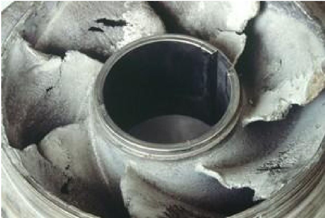
FIGURE 1.8 – Pompe centrifuge détruite par la cavitation
